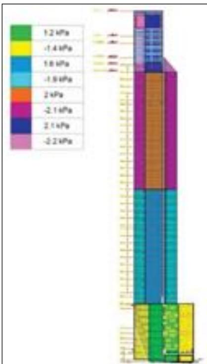
Fig. 11 : Wind Pressure Thro IS Code
