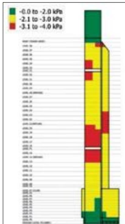
Fig. 12 : Wind Pressure Thro Wind Tunnel
